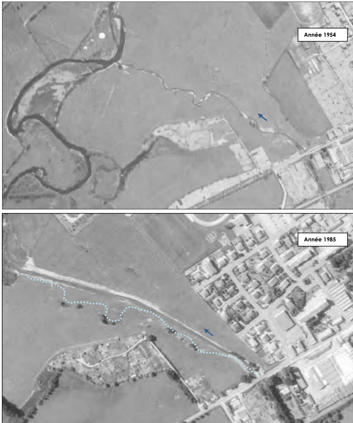
Figure 3-5 Vues aériennes comparatives du tracé du lit du Bezo entre 1954 (physionomie naturelle particulièrement sinueuse – image haute) et 1985 (lit de tracé rectiligne et uniforme - image basse, avec projection de l'ancien tracé) - Sources : géoportail.fr & IGN.
