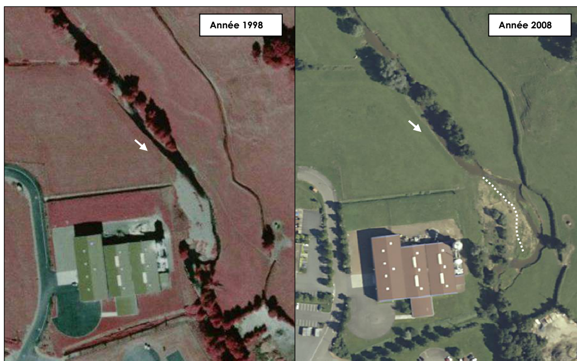
Figure 3-4 Illustration de la progression du lit du Bezo vers l'Est sur une décennie (1998-2008) par engraissement de la rive convexe (l'intrados du méandre) puis l'érosion de la rive concave (extrados du méandre) ; évolution ayant débuté dès le début des années 1980, soit à la suite immédiate des travaux de chenalisation de la rivière menés en aval de la route départementale n°487 - Sources : géoportail.fr & IGN.
